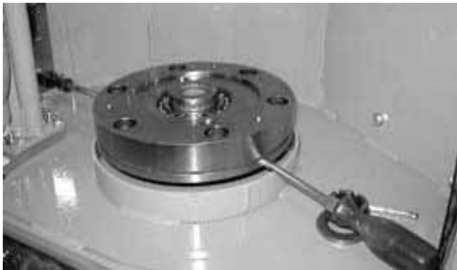
Afbeelding 7.8.1 Montage koppeling in de machine
